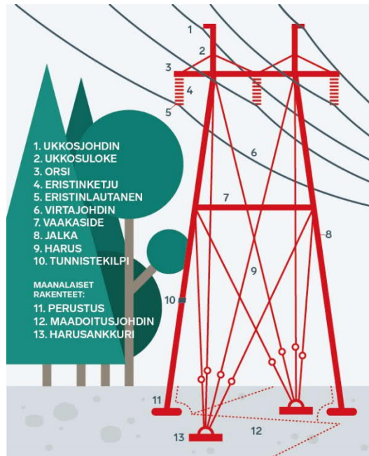
Kuva 3-3. Voimajohdon osat (Fingrid 2020).
